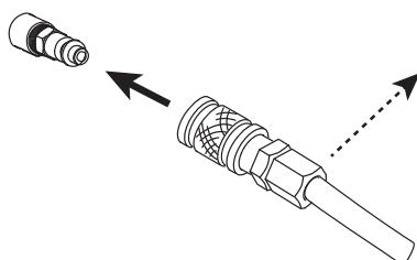
Collegare l'alimentazione gas alla fonte di corrente per mezzo di un tubo a gas inerte di diametro interno di 9,5 mm e di un commutatore a raccordo rapido.
