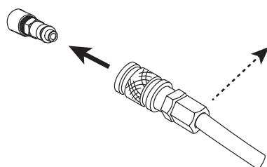
Koppel de gastoever aan aan de voedingsbron met behulp van een gaslang (inert gas) met een binnendiameter van 9,5 mm en een snelkoppeling.
