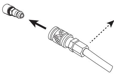
Conecte el suministro de gas al generador mediante un conducto de gas inerte de un diámetro interno de 9,5 mm y un acople rápido.
