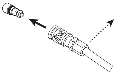
Schließen Sie die Gasversorgung über einen Inertgasschlauch mit einem Innendurchmesser von 9,5 mm und einer Schnellkupplung an.
